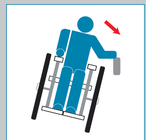
Kippen beim seitlichen Aufnehmen eines Gegenstandes
