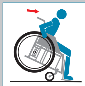
Überschlag bei starkem Abbremsen aus der Rückwärtsfahrt
